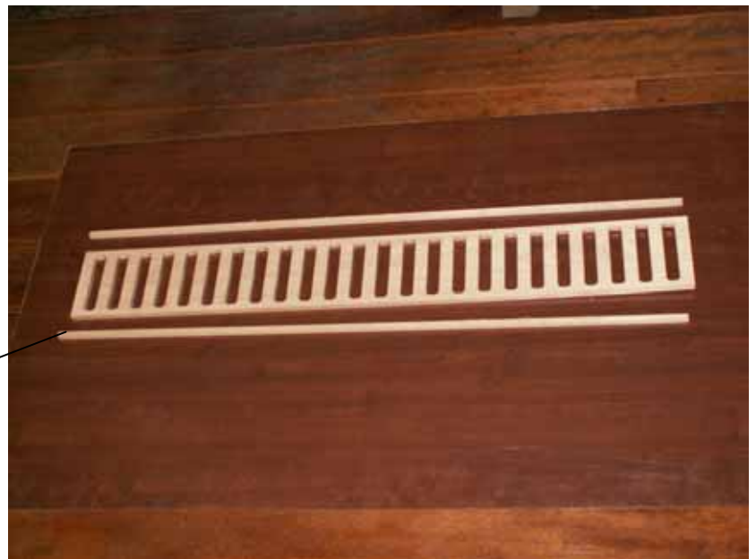
アルダー無垢板 NC 加工状況 (試作)。
