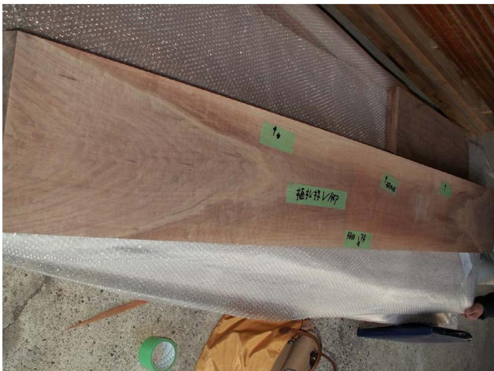
板脚用板も同様に仕上げて、小さなひび割れ等を考慮してV字板の接合面を決定します。
