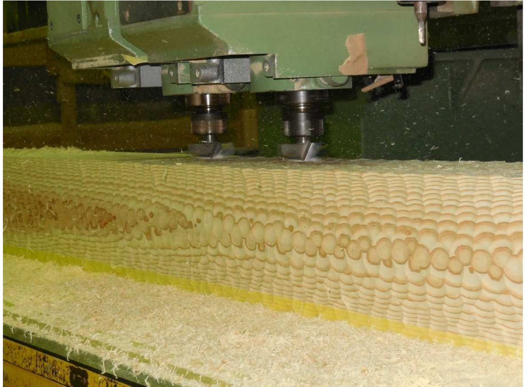
NC 加工中で、長尺物の加工状況です。
